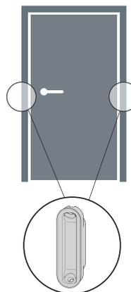
Одинаковая фрезеровка петлевой и замковой стоек коробки.
